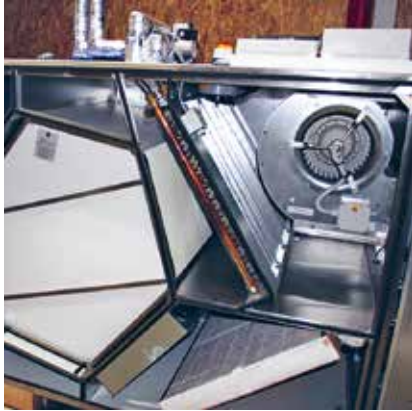
Innenansicht Lüftungsanlage mit Wärmetauscher
